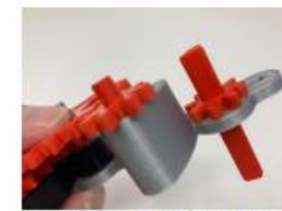
9. 將較長的一端插入「④右車架」的後軸孔，並確保能自由旋轉
