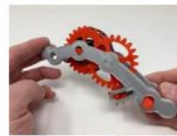
10. 將「⑤左車架」和「④右車架」的前中後定位銷與定位孔緊固組合
